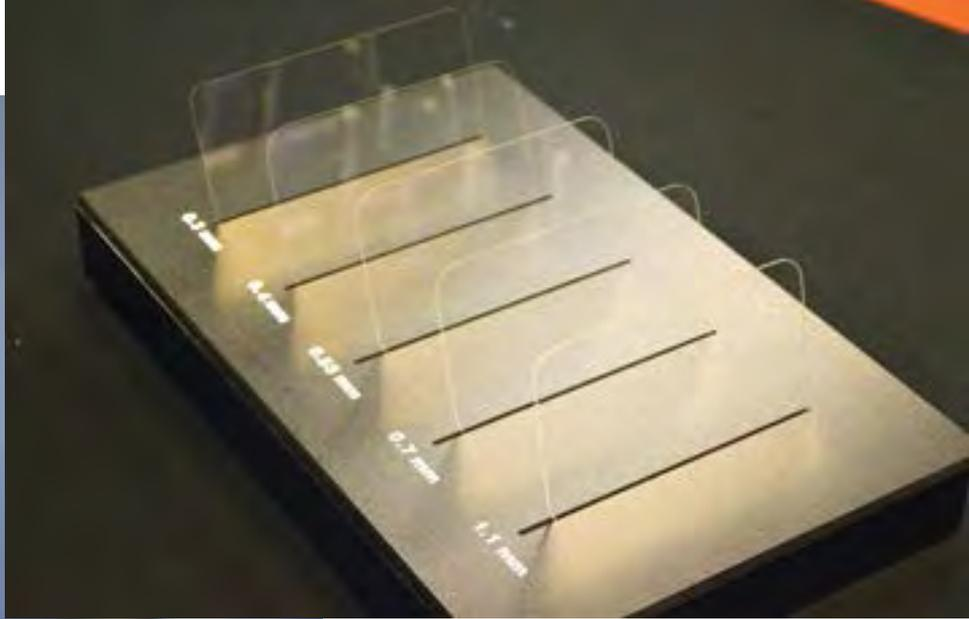
*Muestra de Gorilla Glass durante un ensayo de flexión.*
