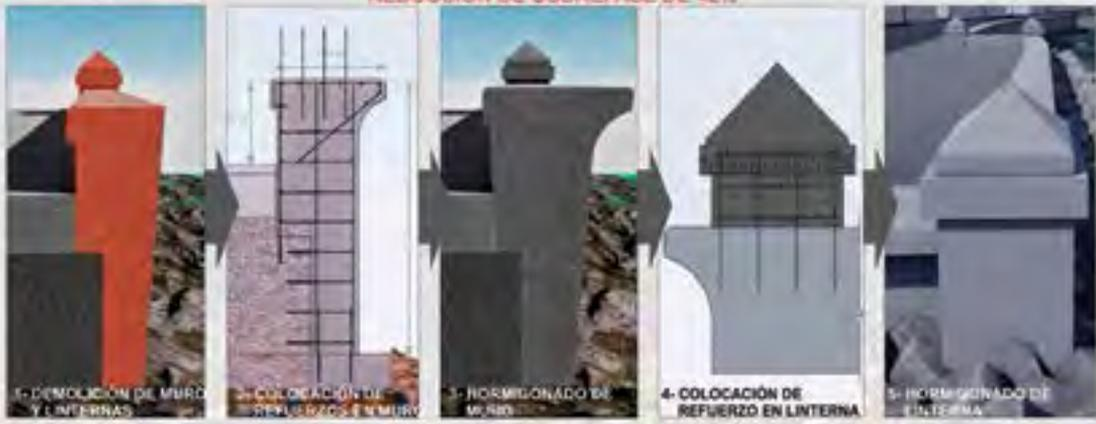
*Se emplearán para la conformación del muro los PRFV por sus características de no oxidación.*
