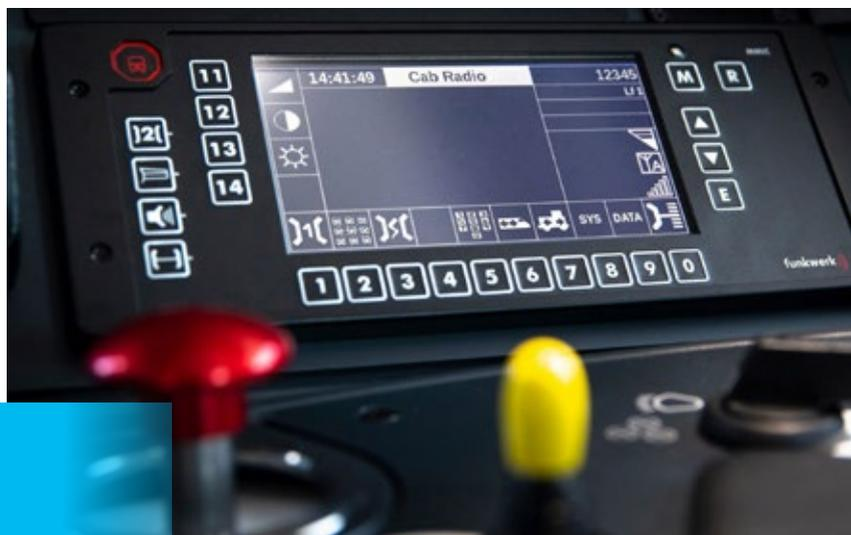
Equipo GSM-R instalado en la cabina de conducción de una locomotora. FUENTE: FUNKWERK.
