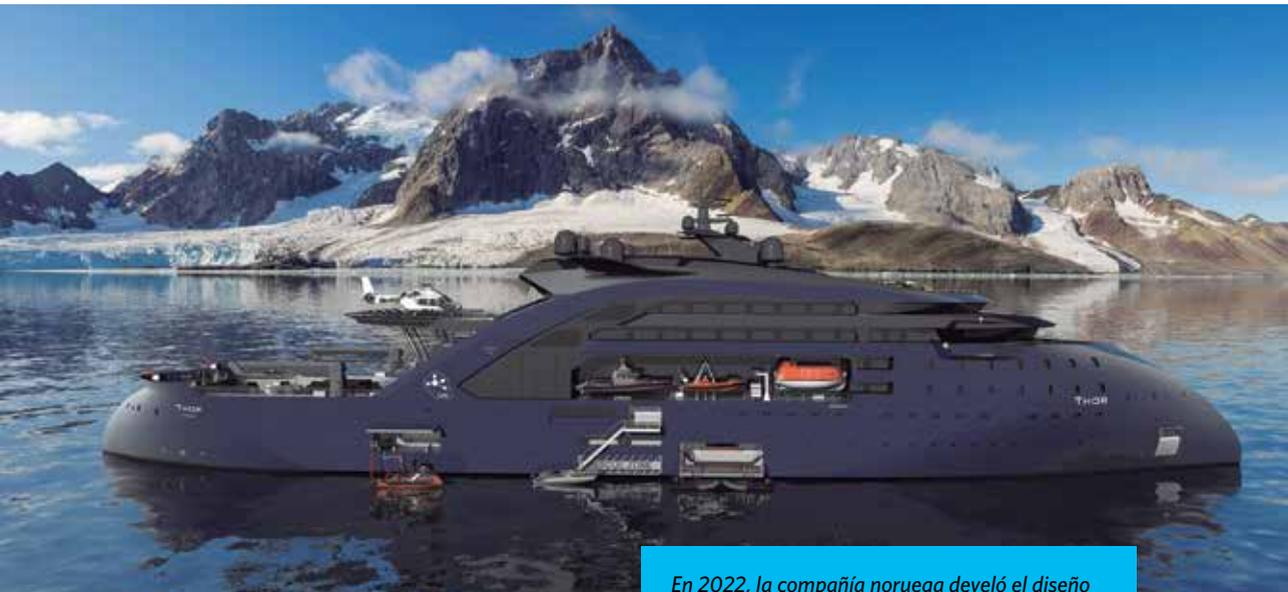
*En 2022, la compañía noruega desarrolló el diseño de Thor, un buque de exploración de 149 metros de eslora, empleado también como central eléctrica alimentada por núcleos de torio, para recargar en alta mar a cruceros que funcionen mediante bancos de baterías. (FOTO: ULSTEIN)*
